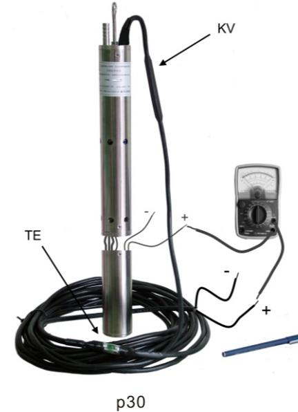
arbeitet nicht mehr. Holt man sie jedoch aus dem Wasser, verbindet sich die gebrochene Stelle wieder, und das Tauchkabel scheint in Ordnung zu sein. Daher die besondere Empfehlung, während des Messens das Kabel mit beiden Händen in einem Abstand von 50 cm Stück für Stück auseinander zu ziehen. Beobachten Sie dabei, ob das Multimeter an einer bestimmten Stelle einen erhöhten Widerstand anzeigt. Dadurch findet man meistens die versteckte Unterbrechung im Kabel.
