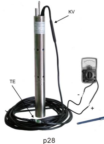
G10.0) Der positive Stift des Multimeters am „+“ Eingang der Pumpe, und der negative Stift am „-“ Eingang der Pumpe müssen einen Widerstandwert von ca. 50-500K Ohm aufweisen,
